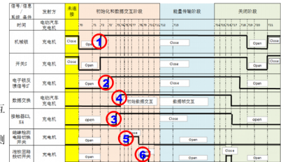
图B.2 直流充电连接控制时序图
